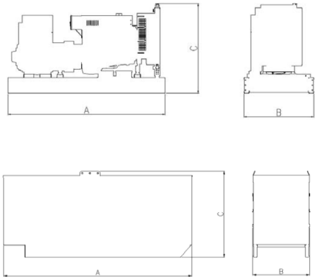
Figura 16: Grupo gerador CUMMINS C1000 D6 [16]
